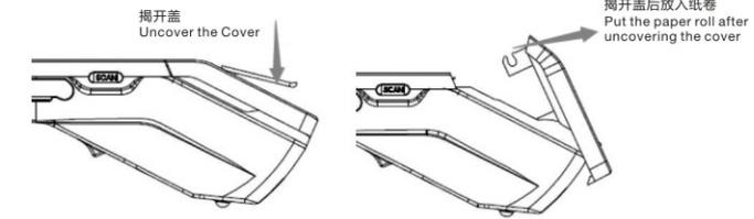
**打印机:** 本设备支持58MM的热敏打印纸, 规格为: 57\*40 (纸卷直径) 单位mm 通过上方的开盖提手揭开打印机的纸仓盖, 按正确的方向, 放入适合规格的纸卷, 并将纸拉出部分纸至切纸器外, 盖好纸仓盖完成打印机装纸。
