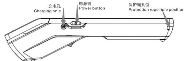
**充电孔:** 外径3.5mm内径: 1.35mm. 输入12V 1.0A进行设备充电。本设备只支持此孔充电, 不支持USB充电, 充电状态时屏幕会有相应图标提示, 如没有充电图标显示, 请检查充电器是否插好到位。此孔应防止进入液体或短路, 禁止插入非指定充电装置!
