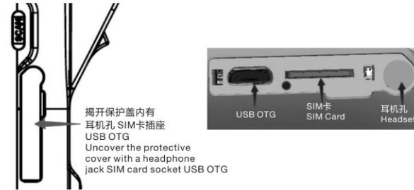
**SIM卡:** 支持MICRO卡插入, 网络支持3G/4G双网通。注意插入SIM时请确认设备处于关机状态下进行操作, 以免造成机器设备故障及不必要的损失!
